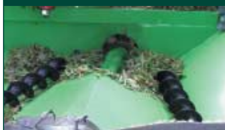
Detalle de los sinfines transportadores de almendra hasta el carrete pelador del equipo de acoplamiento trasero.
