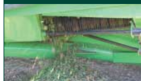
Detalle de la ventana de expulsión de restos de la despellejadota del recolector trasero.
