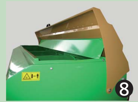
Chapa deflectora bajo tapa depósito para evitar derrame de semilla.
