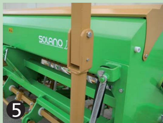
Fusible de seguridad anti-choque en el brazo trazador.
