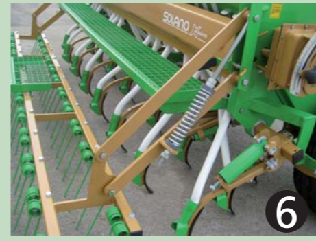
Sistema de sujeción rastrilla con muelle de presión reforzado, encasquillado en nylon para evitar desgastes.
