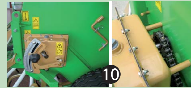
Variador de velocidad para una total precisión en la dosis de siembra. Se incorpora agitador rotativo continuo.
