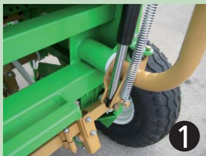
Nuevo sistema integrado trazador. Encasquillado en nylon con eje sobredimensionado.
