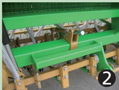
Regulación de la profundidad del tren de enterrado. Muy accesible.
