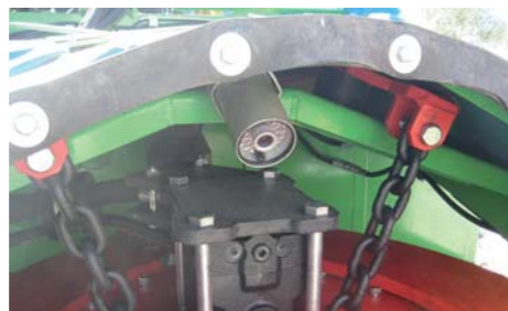
Cámara de circuito cerrado para la visualización desde cabina del manipulador.
