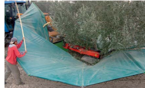
Paraguas abatible. Permite ayudar a la caída de aceitunas de variedades de difícil desprendimiento.
