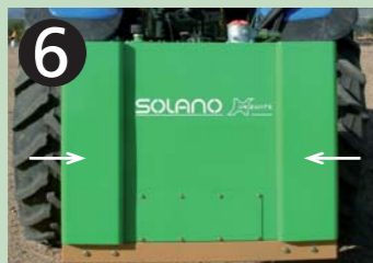
6 Contrapesos en módulo trasero para equilibrar el peso entre ejes.
