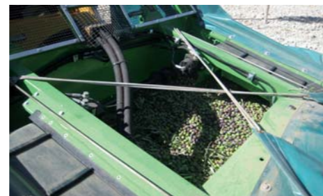
Vista de depósito almacén. Se aprecia a ambos lados las cintas transportadoras del fruto.
