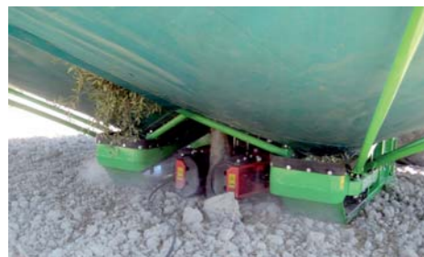
Detalle de la situación de la pinza en el punto más bajo posible de cogida al tronco optimizando al máximo el derribo del fruto.
