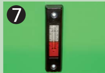
7 Control nivel aceite y temperatura.
