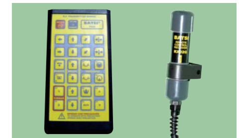
Equipo emisor - receptor vía radio
