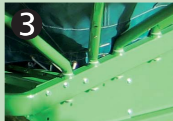
3 Casquillos de nylon en ejes macizos de giro de brazos de paraguas, evitando desgastes y engrases.
