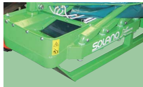
Detalle sistema abatible de brazos y casquillos de nylon en ejes para evitar desgastes y engrases.
