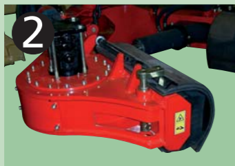
2 Fácil y cómodo cambio de mazos de goma pinza vibrador.
